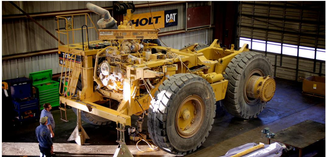
Abbildung 18: Zerlegung für Erneuerung eines Grossladers (Quelle: Holt Cat)
