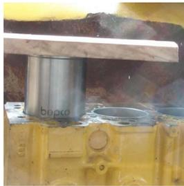
Beispielsweise wurde für einen Motor eine austauschbare Manschette für die Zylinderbohrungen entwickelt. Dies erlaubt es, beim Auffrischen die Manschette zu ersetzen anstatt eine Zylinderbohrung vornehmen zu müssen, welche den Durchmesser vergrössern würde. So kann der Motor mit demselben Kolbendurchmesser wieder eingesetzt werden.
